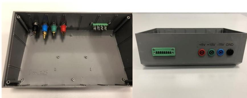
Abbildung 36 Innen und Außenansicht Spannungsversorgung OP-Trainer
