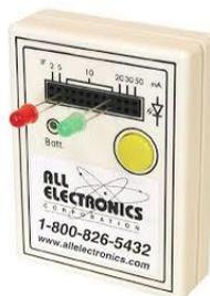
Abbildung 16 LED Tester zur Bestimmung des Betriebsstromes
