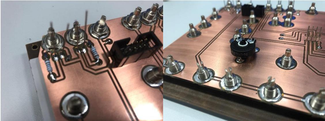
Abbildung 33 Bestücken und Löten der Hauptplatine
