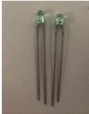
Abbildung 31 Zylindrig schleifen der 3mm LEDs
